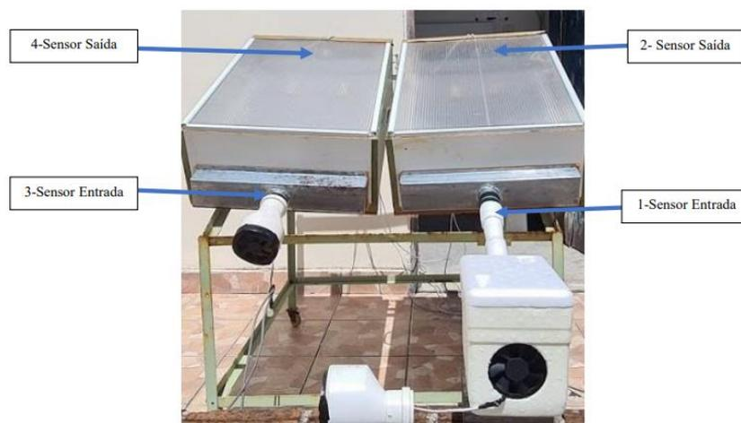
Fig. 1 – Sistema de secagem: Secadores e componentes. Secador 1 (à esquerda) sem sílica gel, e secador 2 (à direita) com sílica gel.
