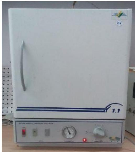
Fig. 5 – Estufa utilizada para avaliação do teor de umidade e massa seca da banana prata.
