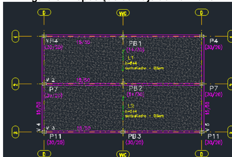
Figura 8. Disposição da Laje do Banheiro.
