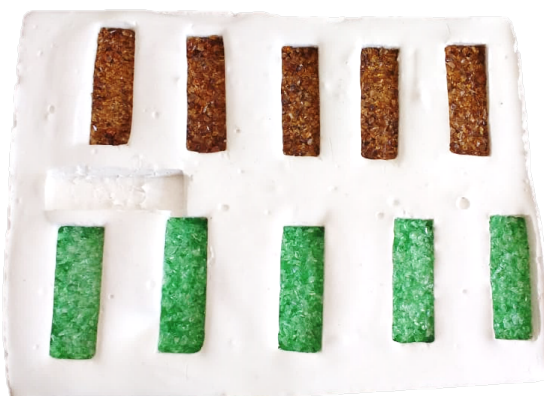
Figura 3: Molde dos corpos de prova confeccionado com gesso, preenchido com vidro (arquivo pessoal).
