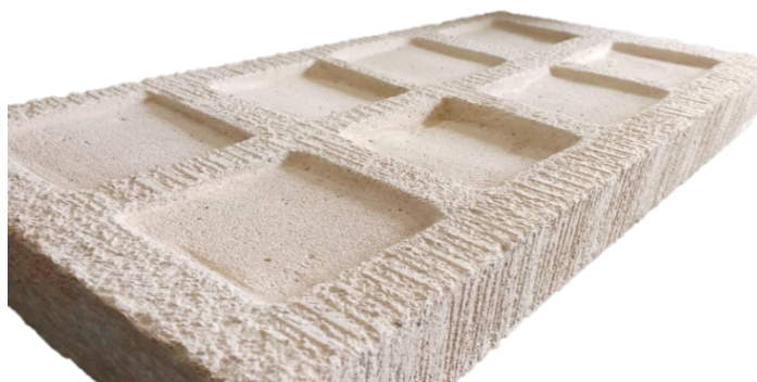
Figura 2: Molde de concreto celular finalizado (arquivo pessoal).
