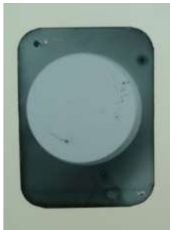
Figura 3-Filme totalmente velado demonstrando o local onde estava a moeda. Indicativo de exposição à luz.
