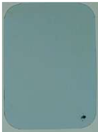
Figura 4- Filme radiográfico sem apresentar velamento. Indicativo de câmara sem entrada de luz durante o processamento.
