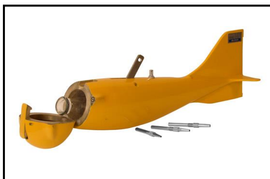
Figura 4 – Amostrador DH- 49 (A)
