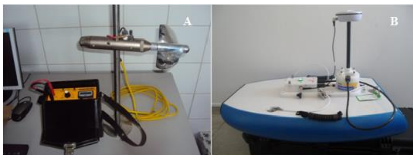
Figura 2 - Molinete fluviométrico com contador eletrônico de pulso (A) e Medidor Current Acústico Doppler (B)
